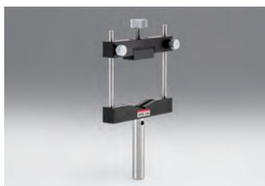
可调镜架可以固定任意外径尺寸的圆形透镜。
